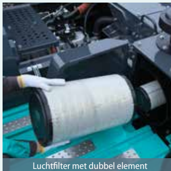
Luchtfilter met dubbel element
