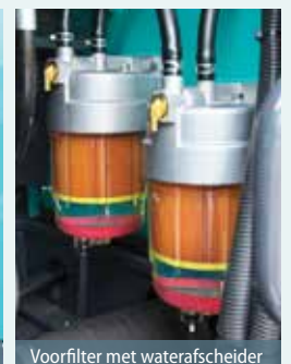
Voorfilter met waterscheider
